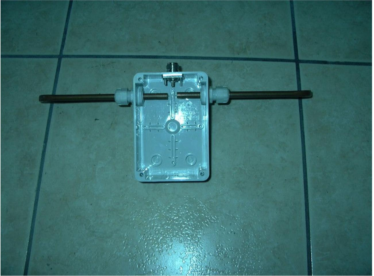
Inserimento dipolo nel box con due pressacavo stagno
